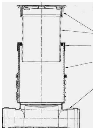
Телескоп - чугунный люк с трубой d 315 мм
